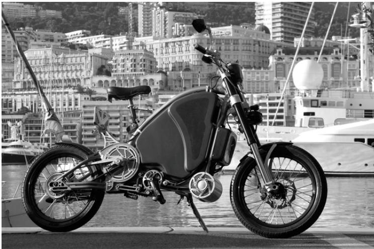
122 mal 2,3 Ah Speicherkapazität wartet es statt eines Gashebels mit Pedalen auf. Die Leistungsabgabe des Elektromotors wird über die Trittfrequenz gesteuert, was die gewollte Analogie zum Fahrrad herstellt und einen zu Beginn glauben lässt, dass sich die FahrerInnen beim Treten zumindest teilweise an der Beschleunigung beteiligen, was aber in der aktuellen Version nicht der Fall ist. Um das eROCKIT mit seinen 114 kg auf deutschen Straßen bewegen zu dürfen braucht
